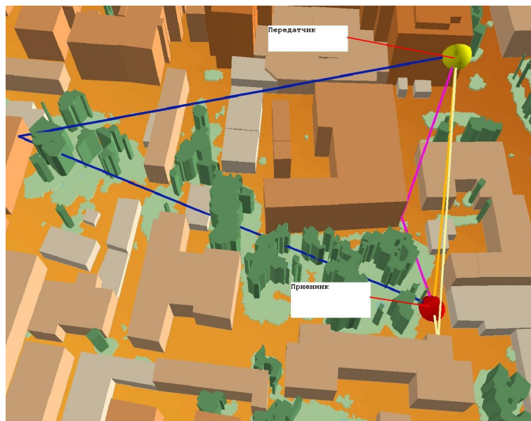
Рис. 4. Пример расчета основных траекторий распространения радиоволн в "ближней зоне".
