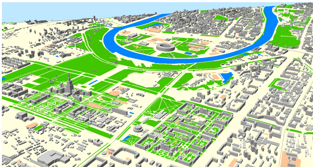
Рис. 1. Внешний вид трехмерной цифровой проблемно-ориентированной модели территории в среде ГИС ArcGIS, служащей основой для создания радиотехнической модели местности и отображения результатов вычислений.
