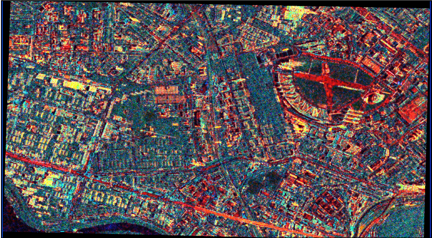
Рис. 10. Геокодированный RGB-композит типа Interferometric Land Use, рассчитанный по двум снимкам TerraSAR-X (Infoterra GmbH). Растительность – зеленая, вода – темно синяя, здания – желтые и красные, дороги и поверхности без растительности – красные. Использованы функции импорта, расчета когерентности, некогерентного накопления, геокодирования и расчета RGB-композиата ILU (Совзонд, 2010).
