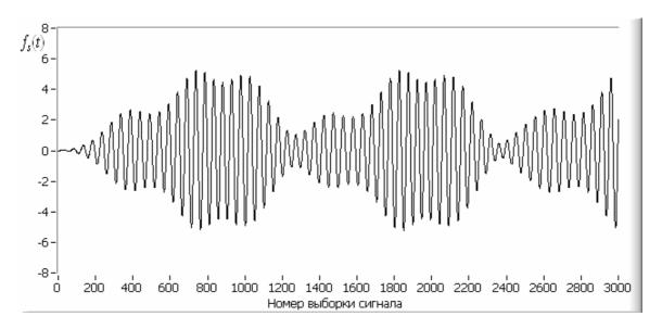
Рис. 3. Результат моделирования функции  $f_r(t)$ . Значение сдвига  $\tau_h$  распределено равномерно, в диапазоне от 0 до  $2\cdot \left\langle \tau_h \right\rangle$ .
