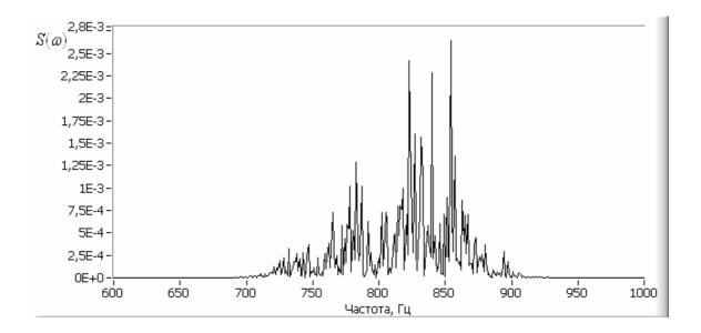
Рис. 4. Спектр модельного сигнала  $f_s(t)$  . Коэффициент вариации интервала следования радиоимпульсов  $\sigma_{\tau_r} / \langle \tau_r \rangle = 0,5$  .
