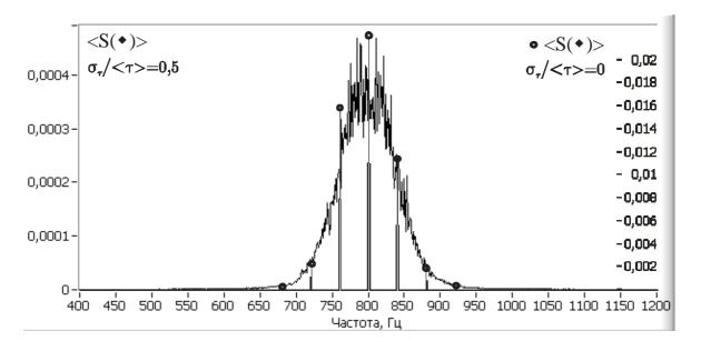
Рис. 5. Спектр мощности  $\langle S(\omega) \rangle$ , усредненный по случайным реализациям сигнала  $f_s(t)$ , при коэффициенте вариации интервала следования радиоимпульсов  $\sigma_{\tau_r} / \langle \tau_r \rangle = 0,5$ . Спектр мощности  $\bullet \langle S(\omega) \rangle$  - при  $\sigma_{\tau_r} / \langle \tau_r \rangle = 0$ .
