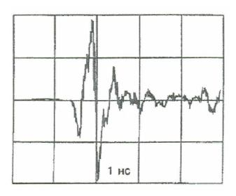
Рис. 1. Форма мощного видеоимпульса генератора
