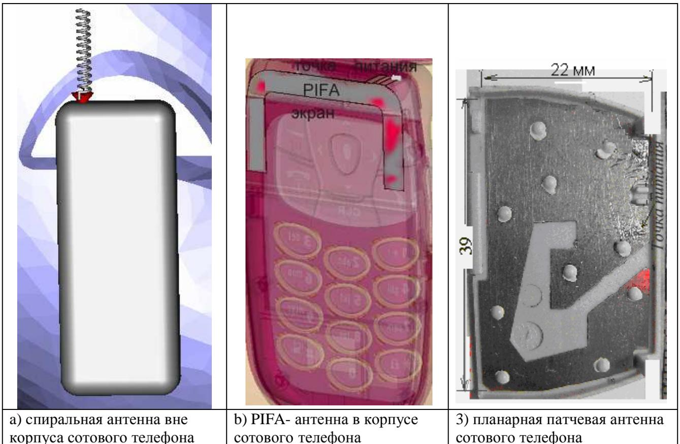
Рис.1. Возможные модели сотового телефона и его антенны.
