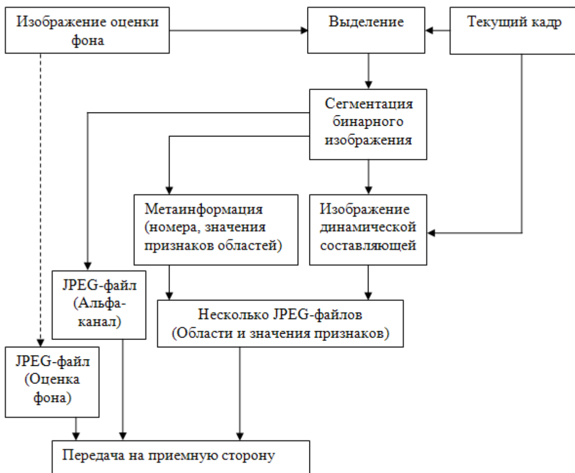
Рис. 5. Блок-схема алгоритма кодирования одного кадра.
