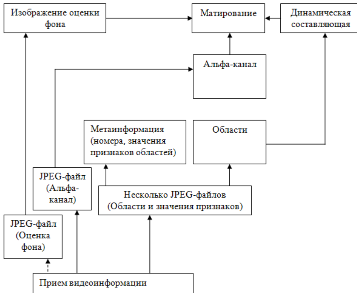
Рис. 6. Блок-схема алгоритма декодирования одного кадра.
