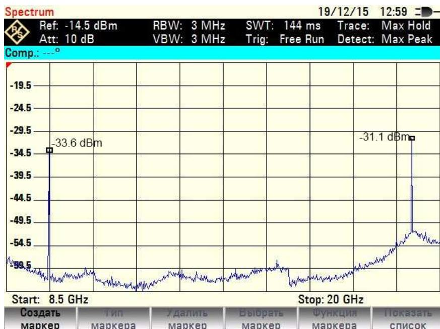
Рисунок 14. – Спектр отраженного сигнала от нелинейной микрополосковой решетки с подложкой из ММ
