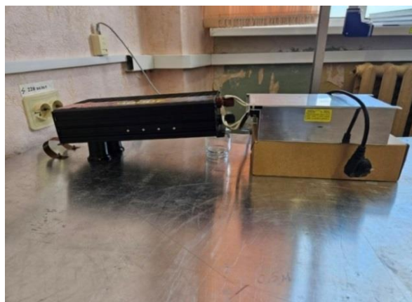
Рис. 1. Схема бортового преобразователя ДЭС (а – схема; б – макет).
