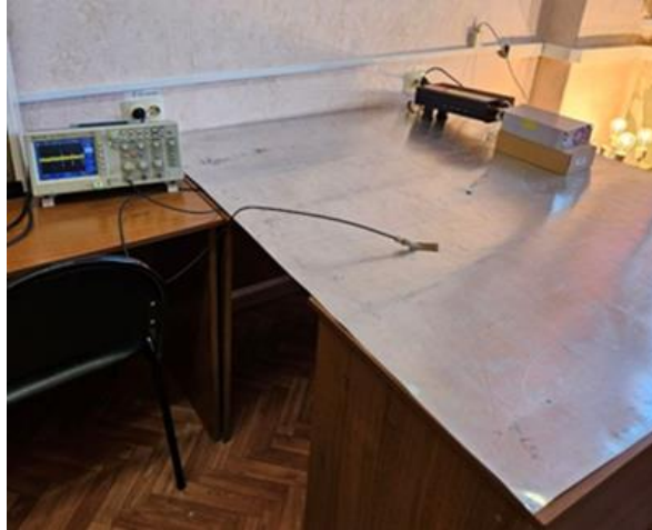
Рис. 2. Стенд для измерения кондуктивных электромагнитных помех.
