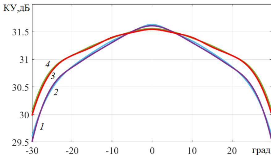
Рис. 12. Зависимости коэффициента усиления антенны от угла сканирования при  $D = 15\lambda$ . Зеркальная антенна: МКЭ (1), Кирхгоф (2); зеркально-линзовая антенна: МКЭ (3), Кирхгоф (4).
