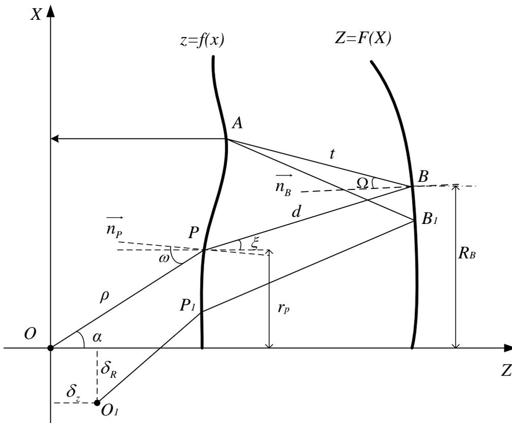
Рис. 4. Геометрия луча при смещении источника из фокуса.
