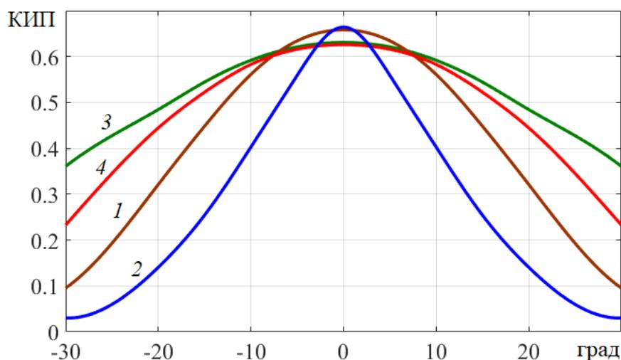
Рис. 15. Зависимости КИП от угла сканирования: зеркальная антенна  $D = 50\lambda$  (1),
