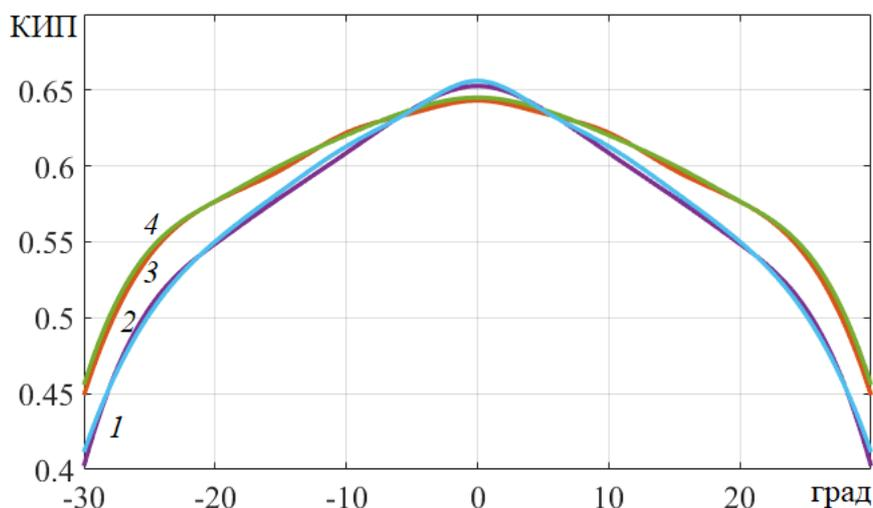
Рис. 13 Зависимости КИП от угла сканирования при  $D = 15\lambda$ .
