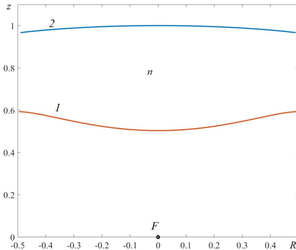
Рис. 6. Образующие линзы (1) и зеркала (2) оптимизированной зеркально-линзовой системы ( $n = 1.3$ ,  $d_0/f_0 = 1.0148$ ,  $\gamma = 0.9371$ ).
