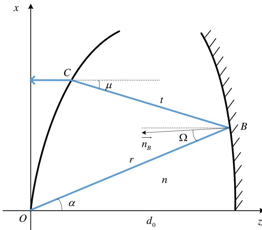
Рис. 3. К выводу дифференциального уравнения для зеркала.
