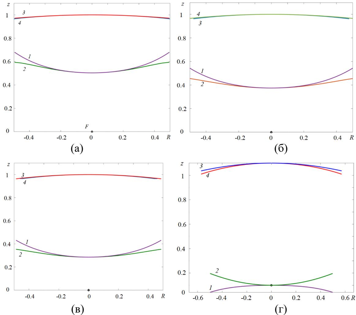
Рис. 2. Образующие зеркально-линзовых систем, найденные аналитическим (1, 3) и численно-аналитическим методом (2, 4):  $f_0/d_0 = 1$  (а), 0.6 (б), 0.4 (в), 0 (г).
