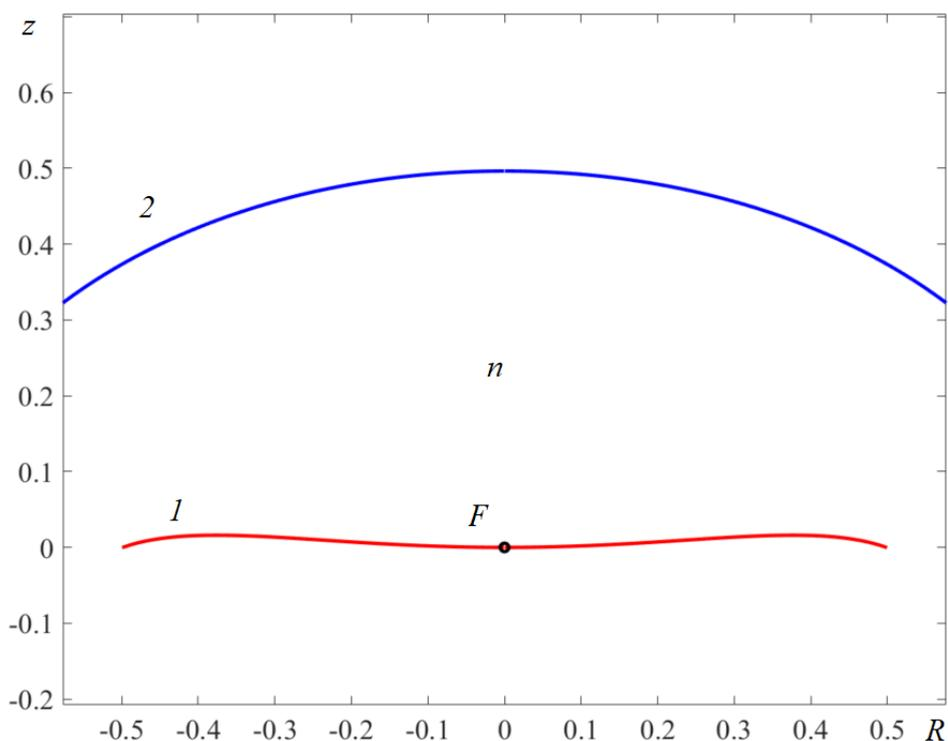
Рис. 7. Образующий зеркала (1) и линзы (2) оптимизированной зеркально-линзовой системы с параметрами:
