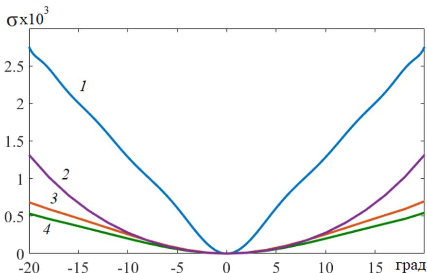
Рис. 8. СКА однозеркальной (1) и зеркально-линзовой системы: (2) – с фокусом на поверхности, (3) – оптимизированной методом трассировки лучей, (4) – оптимизированной по формуле (20).
