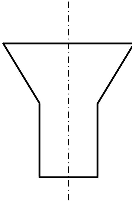
Рис. 9. Продольное сечение рупорного облучателя.
