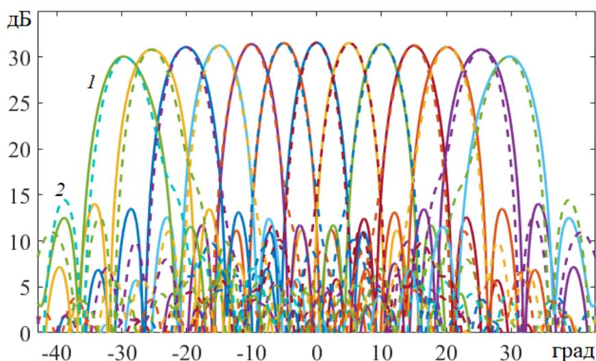
Рис. 11. Диаграммы направленности лучей зеркально-линзовой антенны: МКЭ (1), Кирхгоф (2).
