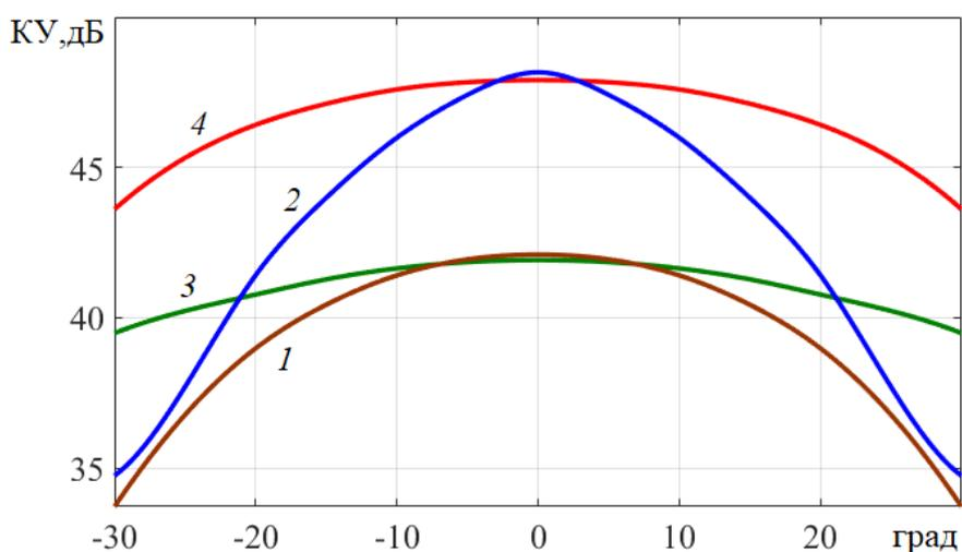
Рис. 14. Зависимости КУ от угла сканирования: зеркальная антенна  $D = 50\lambda$  (1),
