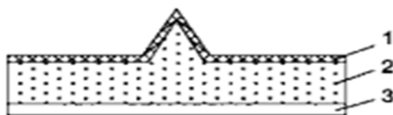
Рис. 12. Конструкция автоэмиссионного катода: 1 – графен, 2 – SiC, 3 – Ti-Au.
