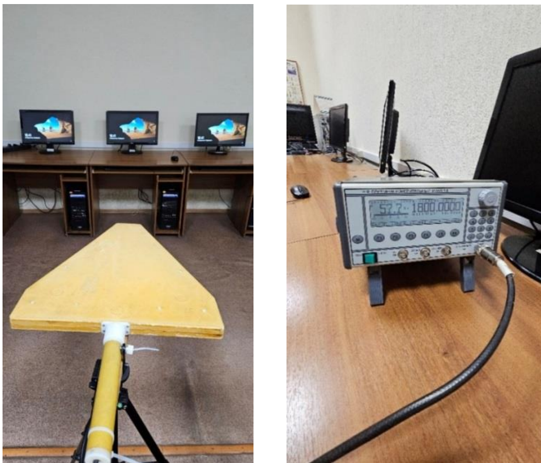
Рис. 1. Стенд для измерения ЭМИ от персональных компьютеров.
