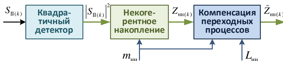
Рис. 3. Обобщенная структура устройства некогерентного накопления быстро флуктуирующего сигнала и компенсацией ПП.
