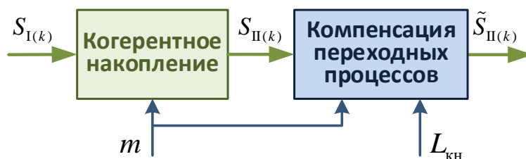
Рис. 2. Обобщенная структура устройства когерентного накопления слабого медленно флуктуирующего сигнала и компенсацией ПП.
