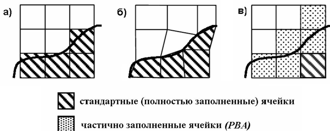
Рис. 9. Сеточная аппроксимация искривленных границ в методе КРВО: стандартная (а), с использованием неортогональной сетки (б) и *PVA* (в)
