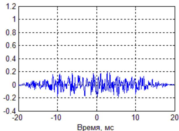
Рисунок 6. Нормированная функция взаимокорреляции различных отрезков хаотического колебания.
