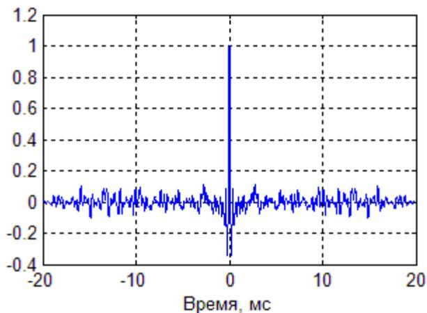
Рисунок 5. Нормированная функция автокорреляции отрезка хаотического колебания
