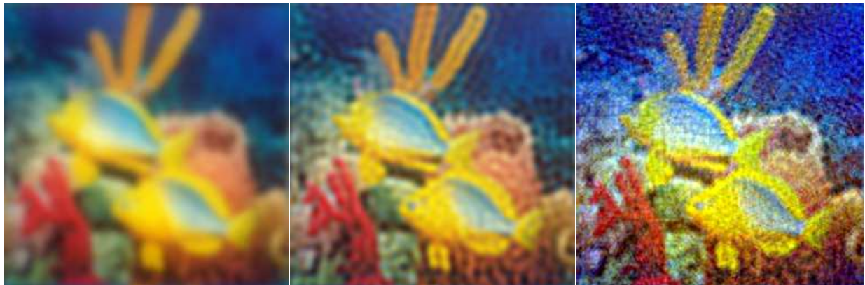
Рис.7. А – изображение, искажённое АФ с S0=10 ; Б – изображение, восстановленное с помощью МВ; В – изображение, восстановленное с помощью МПО. Восстановление производилось при известном ГЛ и неизвестных БЛ. S0=10, kb=0.0473 .
