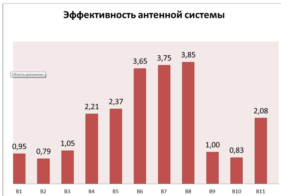
Рис. 2. Результирующие показатели эффективности различных типов антенн для ММП (номера вариантов соответствуют приведенным выше)
