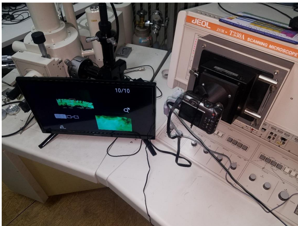
Рис. 1. Общий вид установки времяразрешенной микроскопии на базе JEOL T-330A с переходником для камеры с новой резидентной программой и выводом изображения на жидкокристаллический дисплей.
