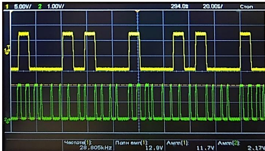
Рис. 10. Результаты измерений при передаче данных со скоростью 115,2 Кбит/с при расстоянии между оптическими модулями 4,5 м: желтый – выход МАХ3232, зеленый – выход компаратора.
