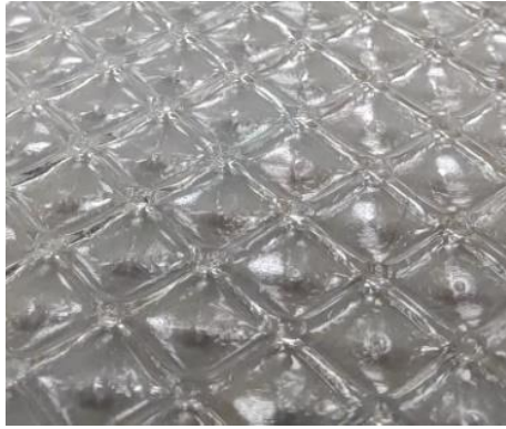
Рис. 8. Матрица пластмассовых линз для фокусировки или для равномерного рассеивания света лент светодиодов.
