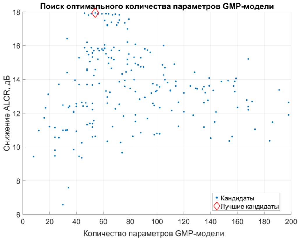
Рис. 2. Результаты поиска оптимального с точки зрения метрики ACLR количества параметров GMP-модели.
