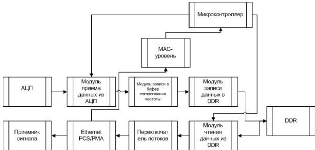
Рис.3. Блок-схема обработки сигнала в ПЛИС приемника РЛС
