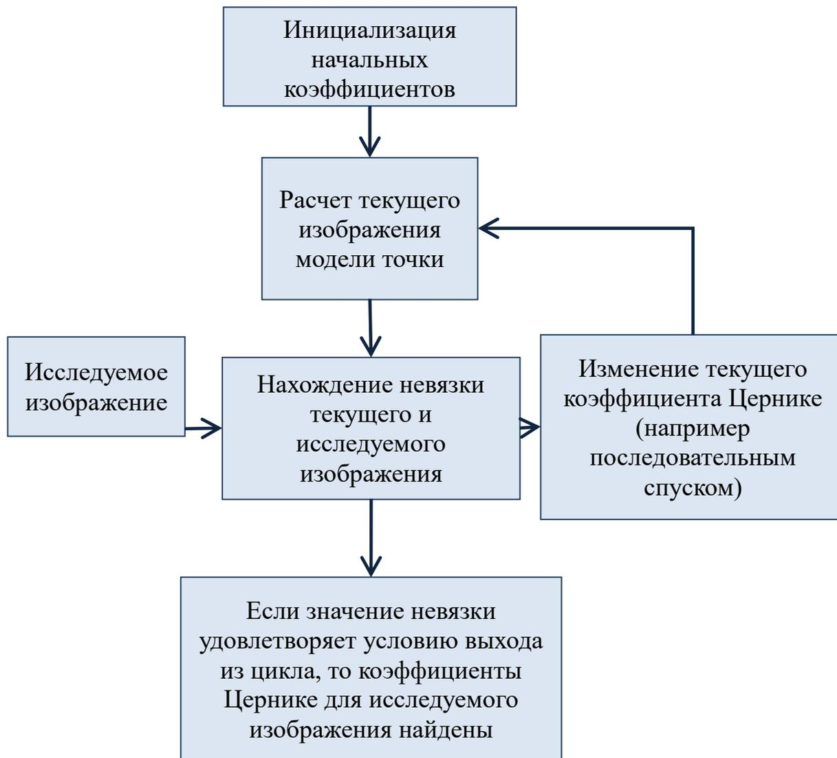
Рис. 5. Блок-схема алгоритма решения обратной задачи.
