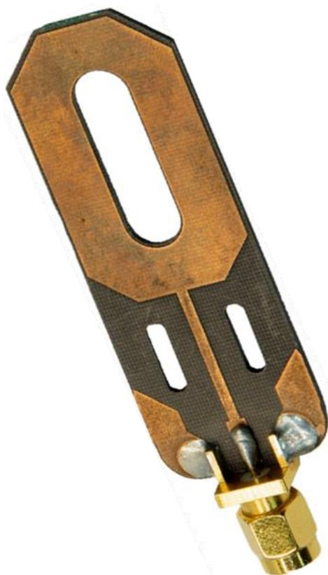
Рис. 28. Спроектированная широкополосная антенна.
