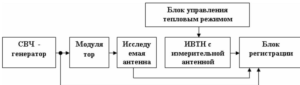
Рисунок 2 – Схема измерительного стенда.
