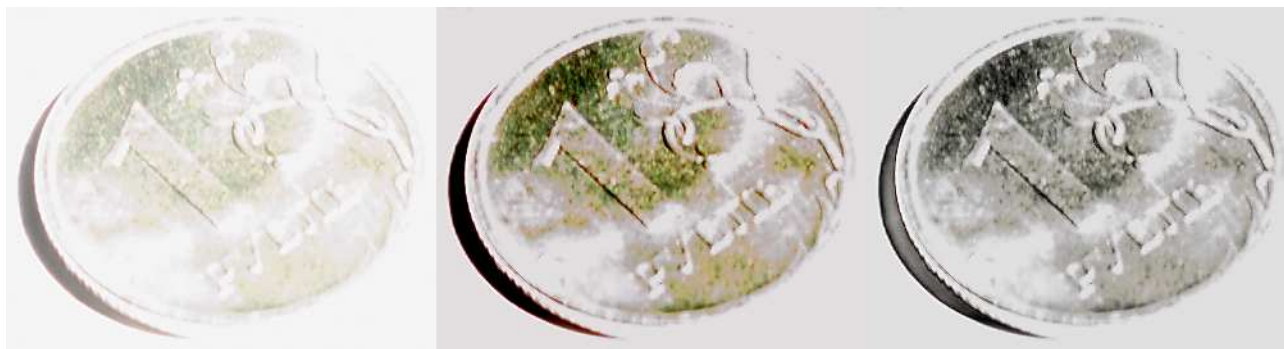
Рис. 2. Слева – исходное изображение, в центре – обработанное средствами Photoshop CS5*, справа – обработанное по оригинальному алгоритму
