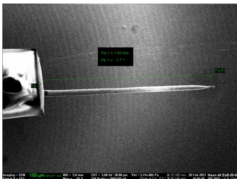
Рис. 3. Изображение системы управления нанопинцетом в СЭМ
