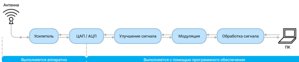
Рис. 2. Схема программно-определяемого радио.
