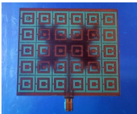
Рис. 26. Антенна на основе второй итерации острова Минковского с метаматериалами в области экрана, вид снизу.
