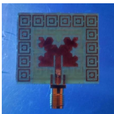
Рис. 23. Антенна на основе второй итерации кривой Коха с метаматериалами в области экрана и патча, вид сверху.
