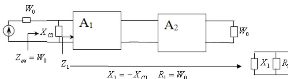
а) схема одностороннего просветления экрана с помощью одной ДР емкостного типа
