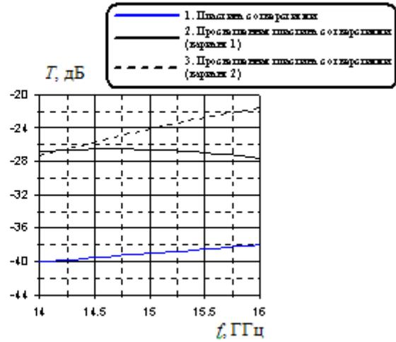
б) Частотная зависимость КП периодической структуры
