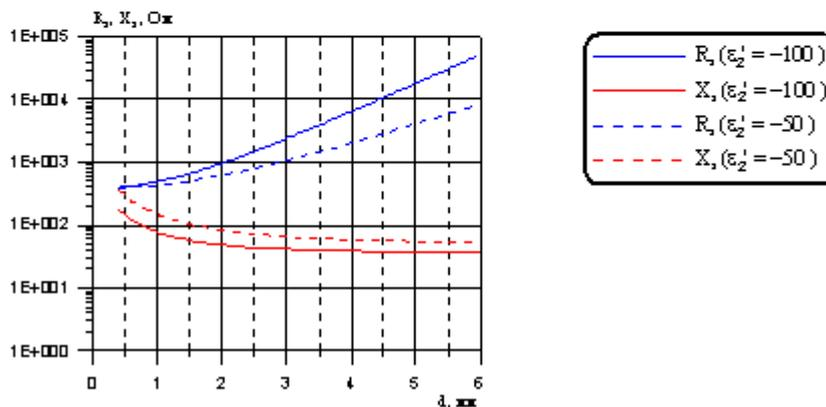
б) зависимость активной  $R_2$  и реактивной  $X_2$  частей поверхностного импеданса просветляемого экрана толщиной  $t_2 = 3,0$  мм
