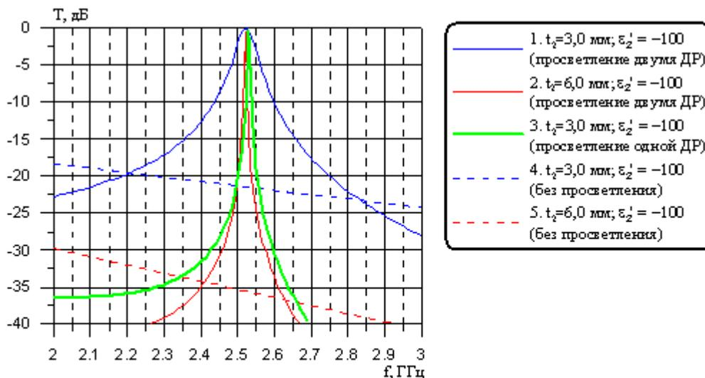
б) расчетные частотные зависимости КП экранов из плазмподобного материала
