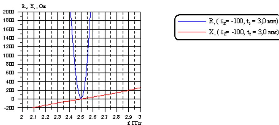
б) зависимость активной  $R_1$  и реактивной  $X_1$  частей поверхностного импеданса просветляемого экрана ( $t_2 = 3,0$  мм  $\epsilon_2 = -100$ ) на расстоянии  $t_1$  58 мм от его поверхности
