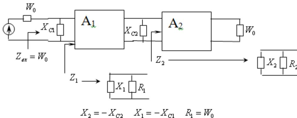
а) схема одностороннего просветления экрана с помощью двух ДР емкостного и индуктивного типов
