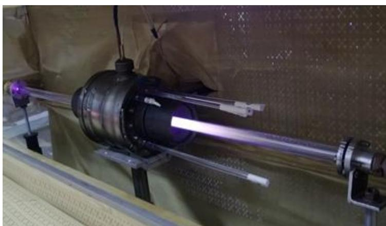
Рис. 9. Фото выходной части СВЧ-разряда
