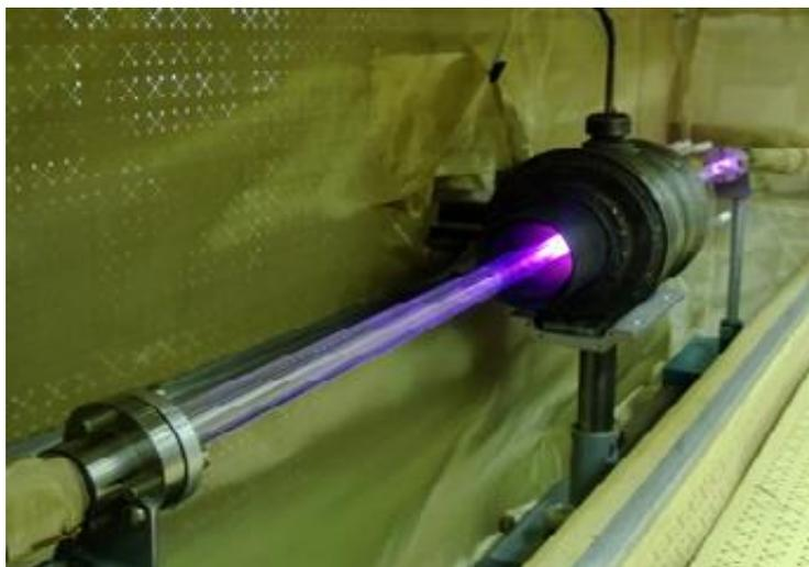
Рис. 8. Фото входной части СВЧ-разряда
