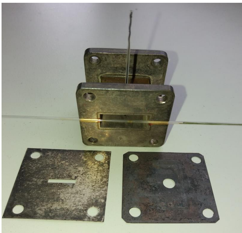
Рис. 2. Диафрагмы связи и резонатор прямоугольного сечения с образцами.
