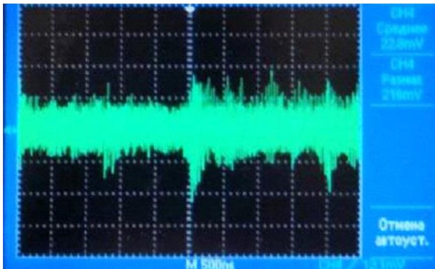
Рис. 1. Развертка зашумленного сигнала тока автоэмиссии.
