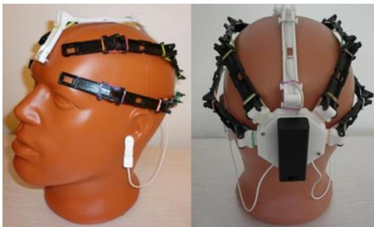
Рис. 1. Макет интерфейса «мозг-компьютер» для проведения частотно-временного анализа сигнала ЭЭГ.
