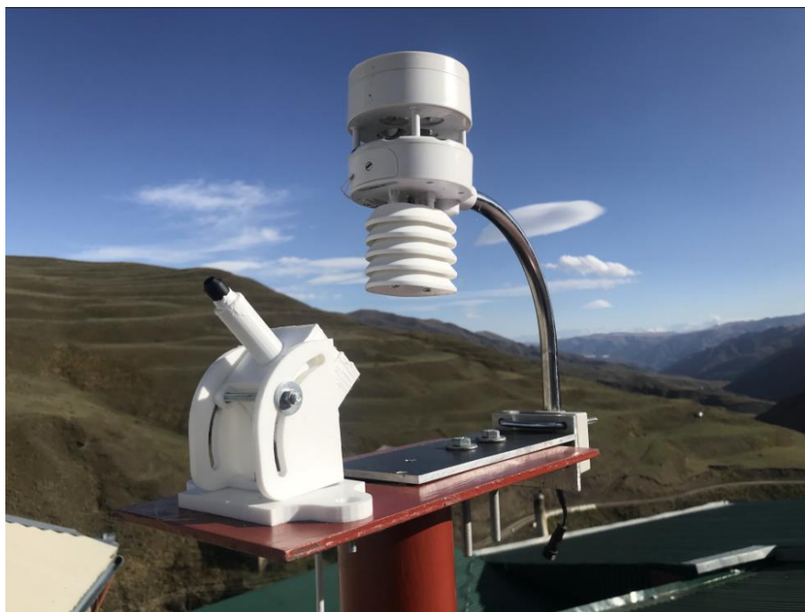
Рис. 29. Оптический монитор Поляр-2 и УЗ метеостанция во время испытаний в высокогорном селе Буршаг (2225 м) Агульского района Дагестана.
