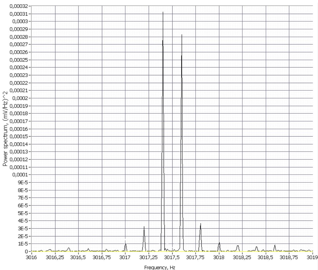
Рис. 4. Спектр мощности сигнала в области 3017Гц.
