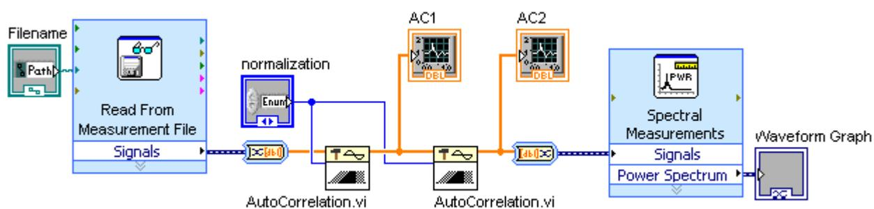
Рис. 3. Графическое представление программы для корреляционно-спектрального анализа сигнала.
