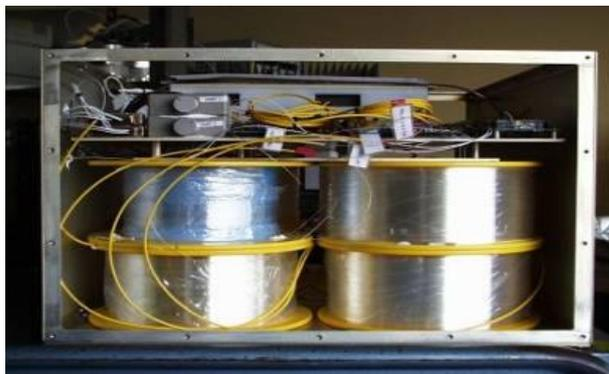
Рис. 19. Фотография типового устройства передачи сигналов от антенн РЛС
