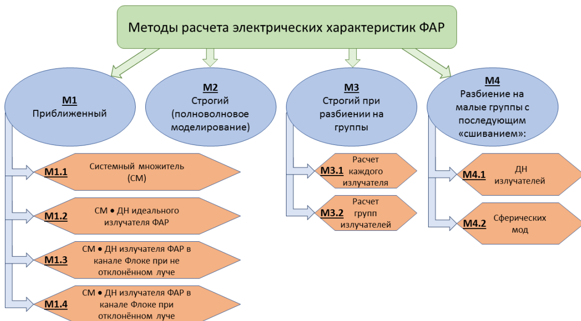
Рис. 1. Методы расчета электрических характеристик полотен ФАР.
