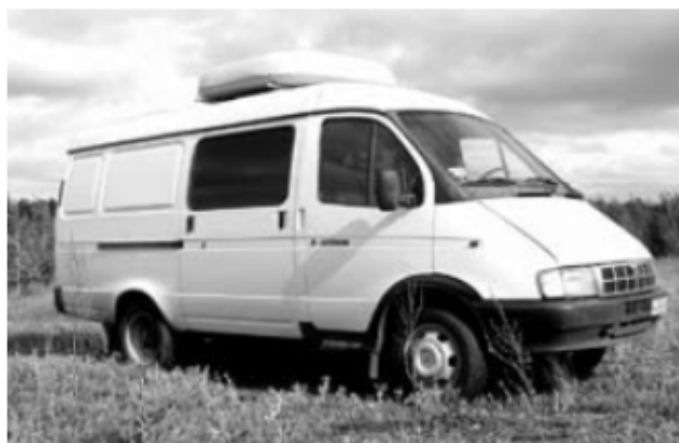
Рис. 1. Мобильный комплекс радиопеленгации (НПП ЗАО «ИРКОС», г. Москва)
