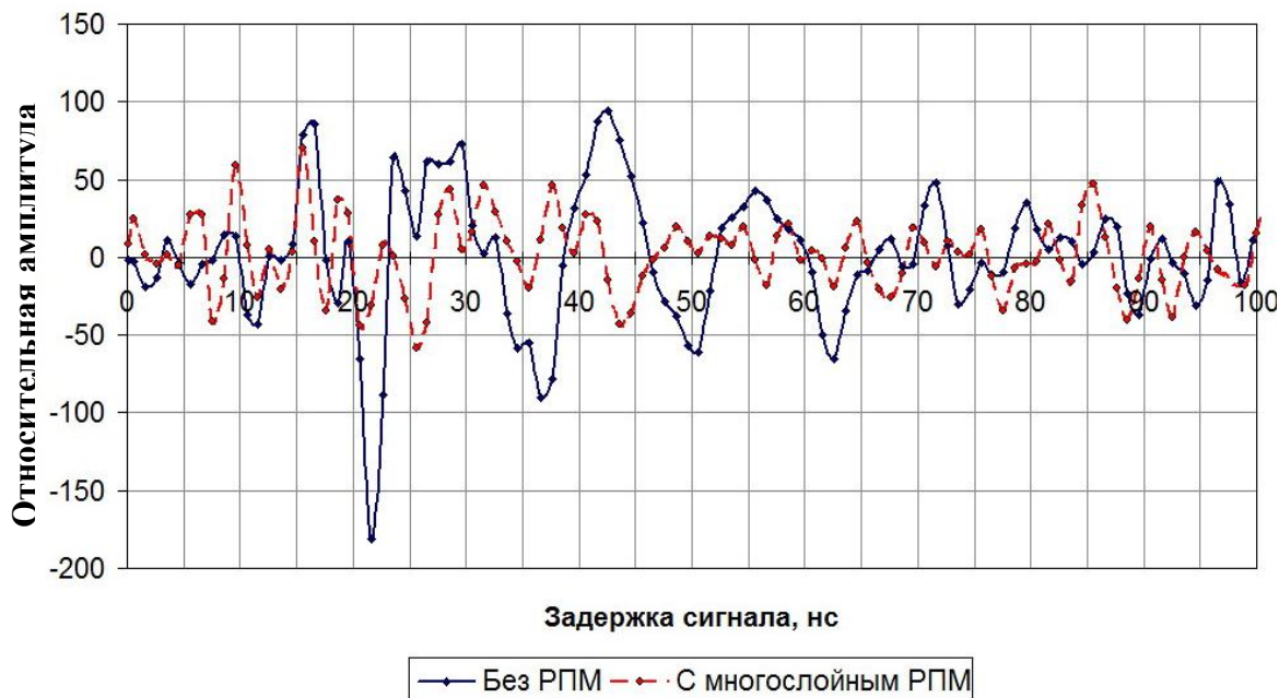
Рис.2. Диаграммы радиолокационного сигнала из подповерхностной среды георадара серии «ОКО-2» при наличии отражений из верхней полусферы.
