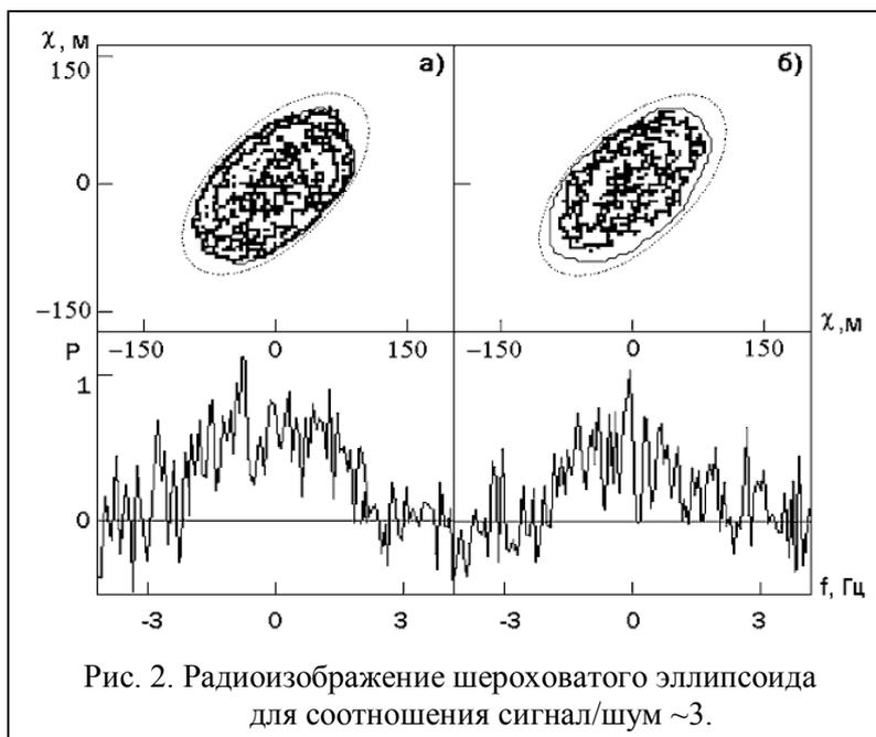
Рис. 2. Радиоизображение шероховатого эллипсоида для соотношения сигнал/шум  $\sim 3$ .
