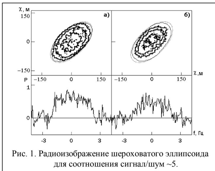
Рис. 1. Радиоизображение шероховатого эллипсоида для соотношения сигнал/шум  $\sim 5$ .
