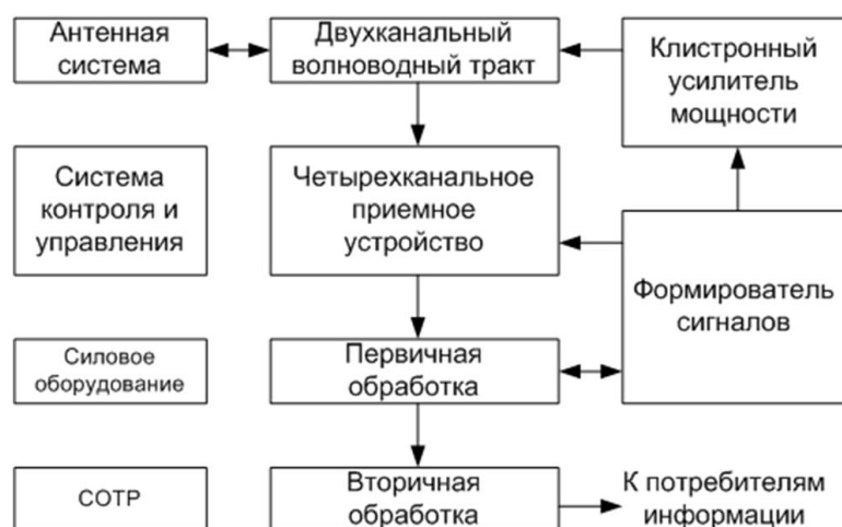
Рис. 7 – Структурная схема ДМРЛ
