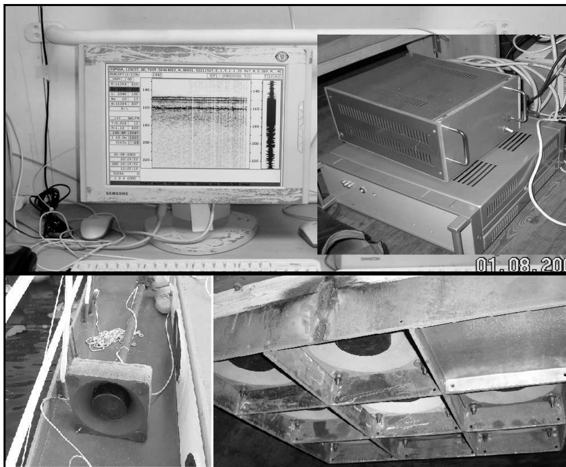
Рис.1. Акустический ЛЧМ профилограф. Сверху слева – монитор оператора, справа – блок усилителя мощности и синтезатор частот, снизу - варианты антенн, слева – одноэлементная антенна на штанге для катерных промеров, справа – девятиэлементная в блоке ледовой защиты под днищем судна.
