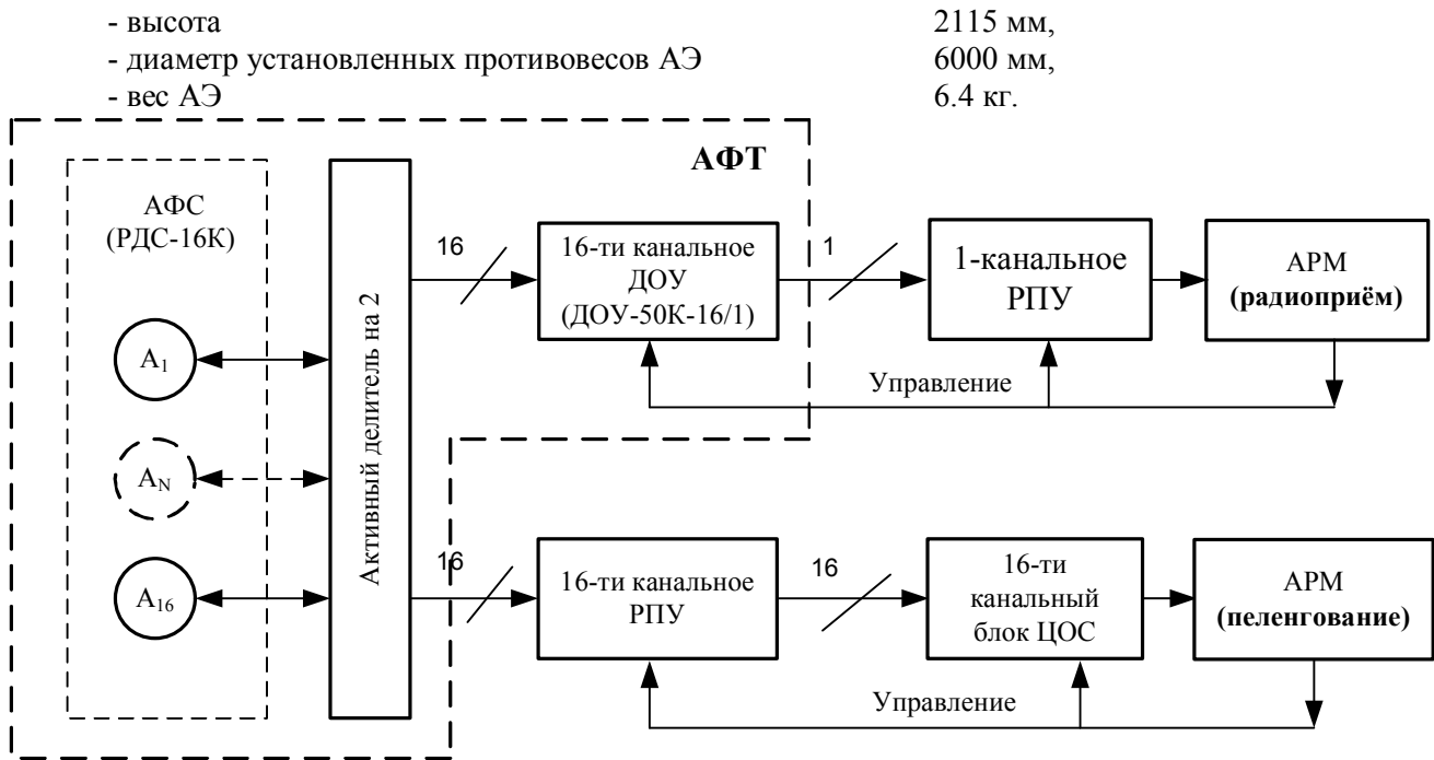
Рис. 1а. Комплекс приёма/пеленгования с АФС РДС-16К (АРМ-автоматизированное рабочее место, ЦОС – цифровая обработка сигналов, АФТ - антенно-фидерный тракт, РПУ – радиоприёмное устройство).
