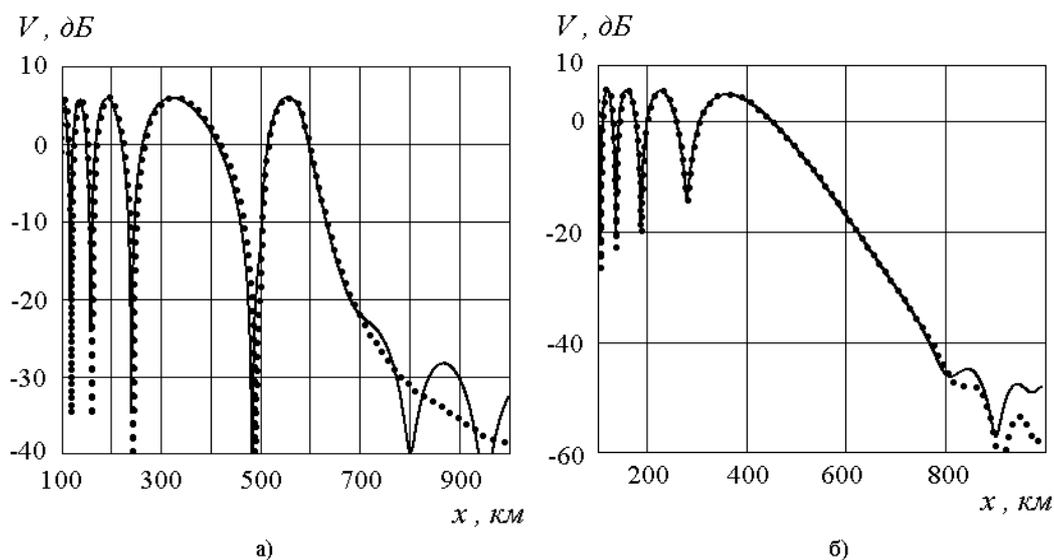
Рис.3. Зависимость множителя ослабления от горизонтального расстояния для клина (а) и цилиндрического сегмента (б). Сплошные кривые - ИУ (7.6), точки - ИУ (6.6)
