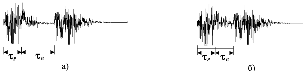
Рис.2. Действие канала на последовательность хаотических радиоимпульсов при длительности защитного интервала больше (а) и меньше (б) длительности отклика канала.
