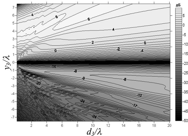
Рис. 2. Множитель ослабления за щелью на горизонтальной поляризации,  $x_0=0$ ;  $y_0=1\lambda$ ;
