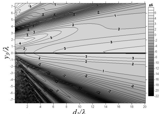
Рис. 3. Множитель ослабления за щелью на вертикальной поляризации.  $x_0=0$ ;  $y_0=1\lambda$ .
