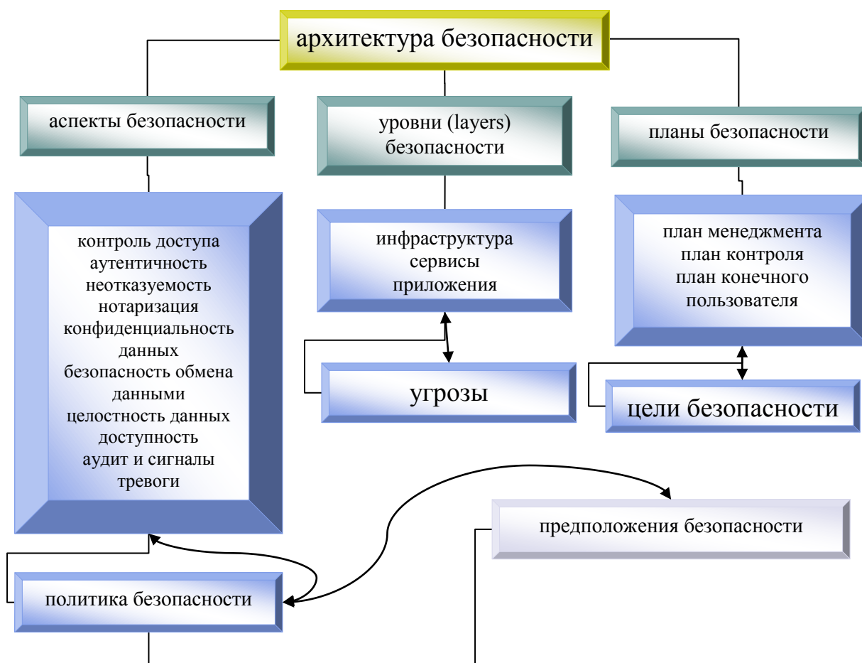
Рис. 1. Архитектура безопасности открытой системы согласно документам серии X.800
