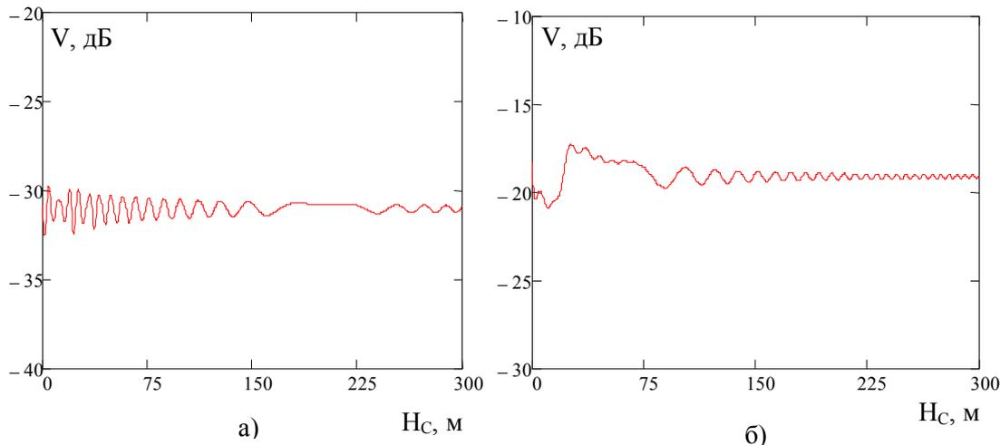
Рис. 2. Зависимость множителя ослабления от высоты слоя над краем препятствия при  $\Delta\varepsilon = 10^{-6}$ . а)  $H = 50$  м, б)  $H = 200$  м.
