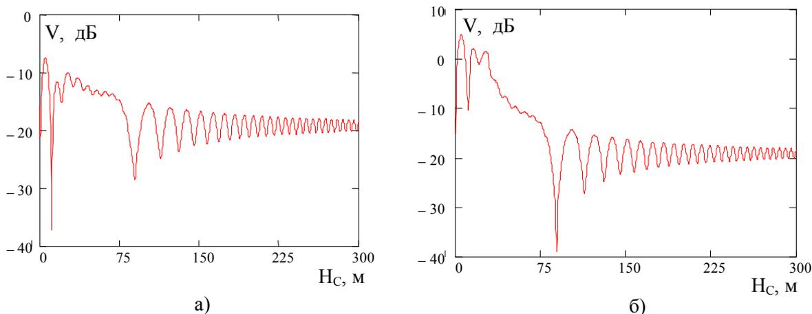
Рис. 3. Зависимость множителя ослабления от высоты слоя над краем препятствия при  $H = 50$  м. а)  $\Delta\varepsilon = 10^{-5}$ , б)  $\Delta\varepsilon = -10^{-5}$ .
