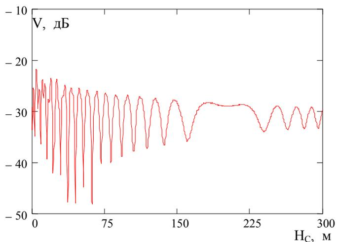
Рис. 4. Зависимость множителя ослабления от высоты слоя над краем препятствия при  $H = 200$ ,  $\Delta\epsilon = \pm 10^{-5}$ .
