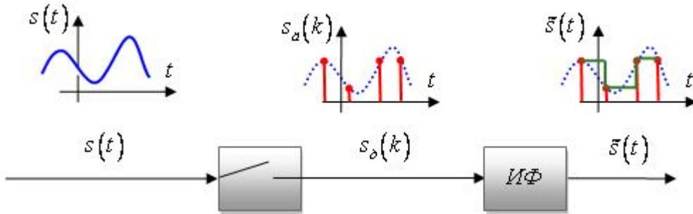
**Рис.1.** Процедура дискретизации и восстановления непрерывного сигнала  $s(t)$
