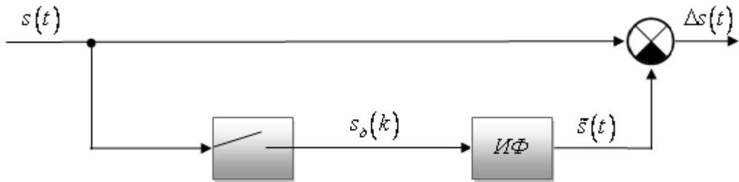
**Рис.2.** Схема устройства, выходным сигналом которого является ошибка интерполяции непрерывного сигнала  $s(t)$  по дискретным значениям  $s_{\Delta}(k)$
