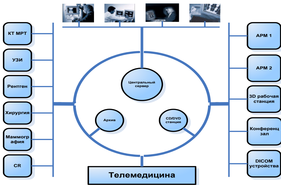
Рис.1 Пример типового решения построения интегрированной ИТ-системы ЛПУ
