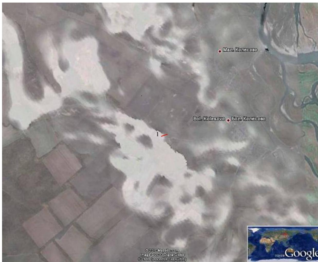
*Рис.2. Геокодированная интерферограмма тестового участка в долине р.Шумиха, совмещенная с изображением веб-портала Google. 1 – наземный георадарный профиль.*
